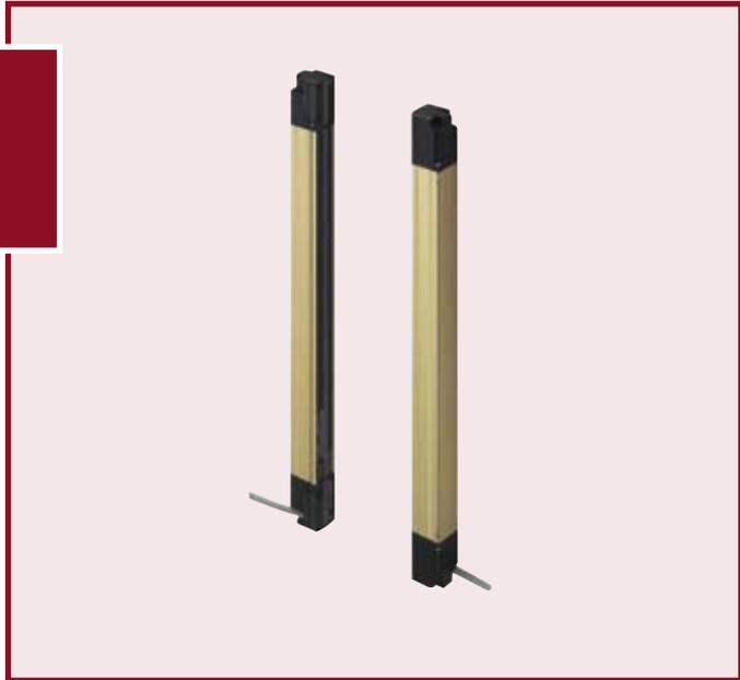
Die Sicherheitslichtvorhänge Typ 4 der Serie SF4B zeichnen sich durch ihre Typenvielfalt und modulare Ausbaumöglichkeit aus. Trotz der kompakten Baumaße ist eine Muting-Steuerung bereits eingebaut. Weiterhin können durch entsprechende Kuppelungen die Geräte lückenlos seriell vernetzt werden. Sowohl bei gerader als auch bei gewinkelter Verbindung entstehen keine Tot-Zonen. Mit dem optionalen Zubehör SFB-HC (Handy-Controller) lassen sich zusätzliche Funktionen einstellen:
