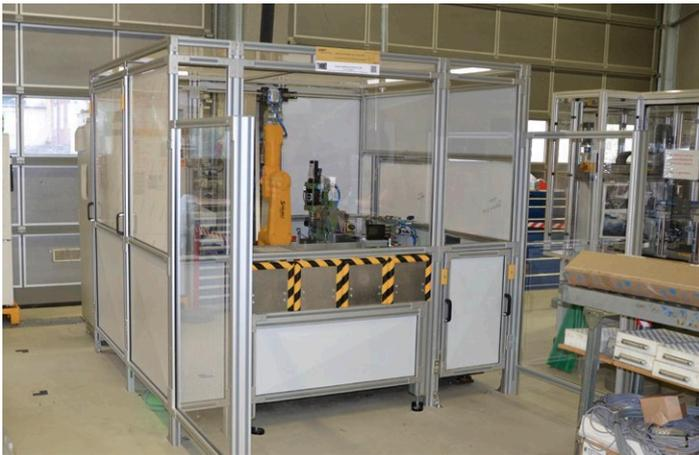
Montageanlage mit integrierter Flex-Line Schutzumhausung, mit pneumatisch angetriebenen SPC-Schubladen
