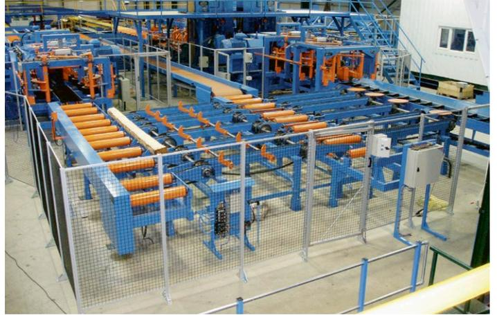
Fördertechnik mit der Easy-Line Schutzumhausung und Füllung aus Punktschweißgitter
