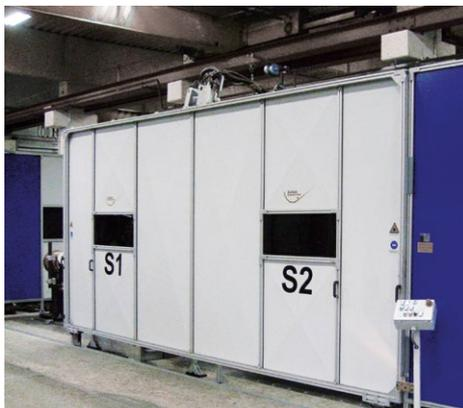
Laser-Schweißanlage mit Blechfüllung und Sichtfester
