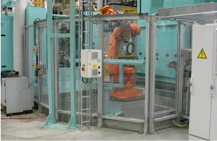
Roboterhandlingsanlage mit Flex-Line Schutzzaunsystem und Polycarbonat Füllung
