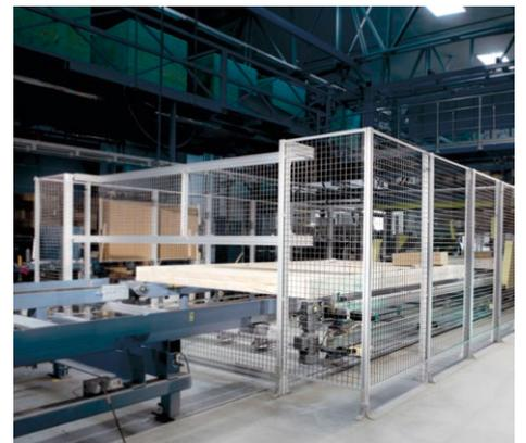
Holzbearbeitungsmaschine mit dem Easy-Line Schutzzaunsystem
