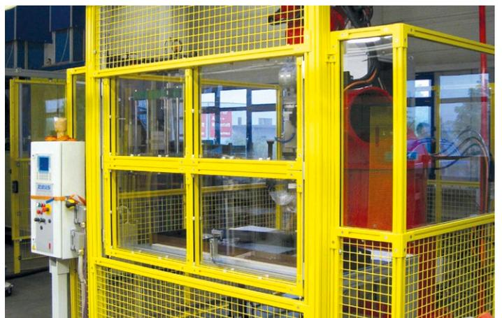
Pneumatisch angetriebenes Hubtor in Gelb gepulvert, Füllung Polycarbonat und Gitter
