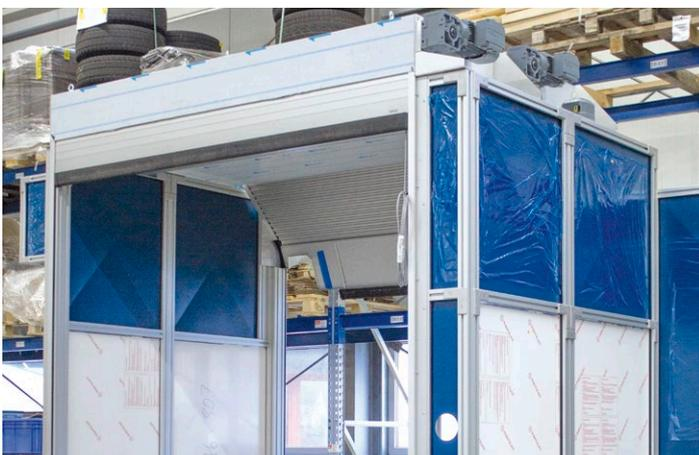
Schutzumhausung mit Polycarbonat Füllung und 2 eingebauten Rolltoren
