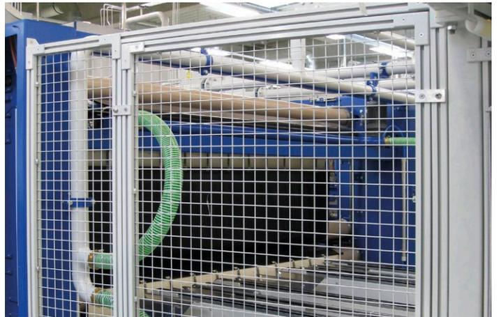
Gepulverter Schutzzaun als Bereichsabsicherung für eine Förderanlage
